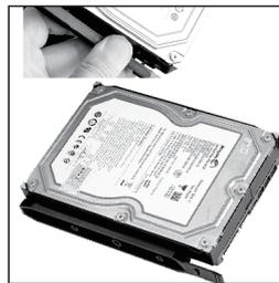
Legen Sie die HDD-Konsole in den Aufsatz hinein.
