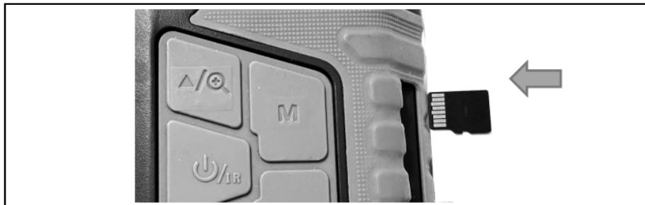
Kartu netlačte do slotu násilím!
