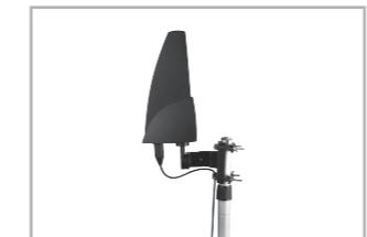
Umístěte objímky ve tvaru U kolem tyče stožáru a přišroubujete k ní držák antény.
