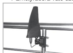
Upevnite pomocou objímkov v tvare U držák antény k vhodnému miestu balkónového zábradlia a nastavte správny uhol držáku proti otočnej časti antény. Našroubujte káble zakončené F-konektorm a upevnite antennu v polohe, kedy je prijem signálu najlepší.
