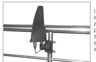
Upevněte pomocí objímek ve tvaru U držák antény k vhodnému místu balkónového zábradlí a nastavte správný úhel držáku proti otočné části antény. Našroubujte kabel zakončený F-konektorem a upevněte anténu k základně v poloze, kdy je příjem signálu nejlepší.
