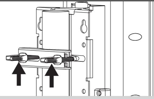
Infilare il cavallotto filettato intorno al palo, inserire il supporto dell'antenna e serrare le viti.
