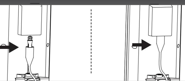
Csatlakoztassa a jelkábelt az antennakimenetőhez, és húzza át rajta a vízálló borítást.
