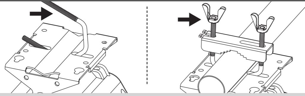
Inserire cavallotto filettato nel foro del supporto dell'antenna e inserire la griffa.
