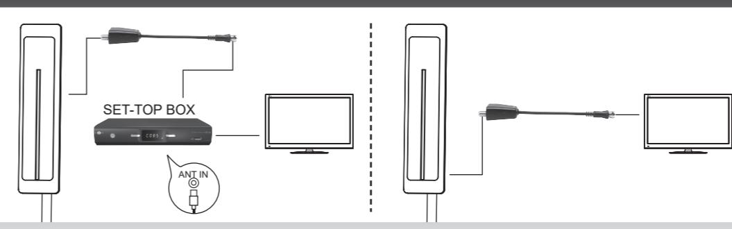
Csatlakoztassa az antennától a tápadapter bemeneti csatlakozójához vezető jelkábelt, az adapter kimenő jelcsatlakozóját csatlakoztassa a digitális jelvevőhöz, és dugja be az adaptort a konnektorba. Aztán csatlakoztassa a kábelt a digitális vevőkészüléktől a TV-készülékbe.
