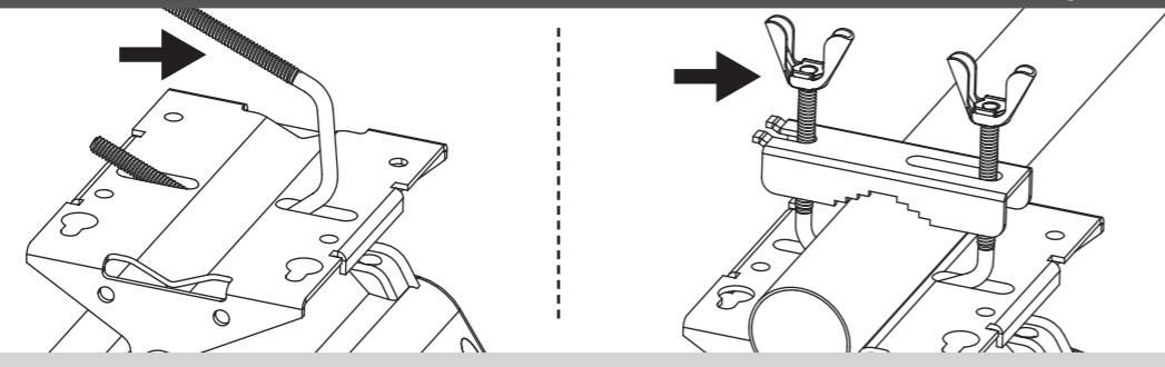
Vložte strmeňovú skrutku do otvoru v držiaku antény a nasadte na neho sponu.
