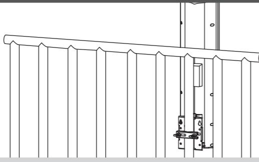
Pomocou strmeňové skrutky pripojte držiak antény k zábradliu a utiahnite skrutky.
