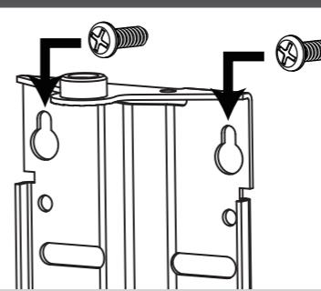
Podle polohy otvorů v držáku antény vyvrťte do zdi otvory a upevněte šrouby. Na šrouby nasadte držák antény a dotáhněte.
