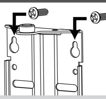
Az antennát tartóján lévő nyílások helyzetének megfelelően fúrjon lyukakat a falba, és rögzítse csavarokkal. A csavarokra illessze rá az antennát tartóját, és húzza meg őket.
