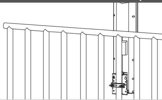
Pomocí třmenového šroubu připevněte držák antény k zábradlí a utáhněte šrouby
