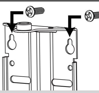
Podľa polohy otvorov v držiaku antény vyvŕtajte do múru otvory a upevnite skrutky. Na skrutky nasadte držiak antény a dotiahnite.
