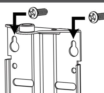
Nach der Position der Öffnungen im Halter der Antenne bohren Sie die Öffnungen in die Wand und befestigen Sie die Schrauben. Setzen Sie auf die Schrauben den Halter der Antenne und ziehen Sie sie nach.
