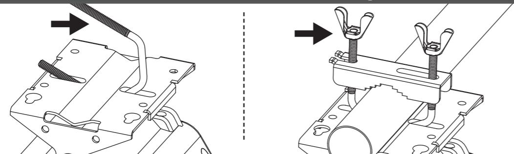
Legen Sie die Bügelschraube in die Öffnung im Halter der Antenne ein und setzen Sie darauf eine Schnalle.
