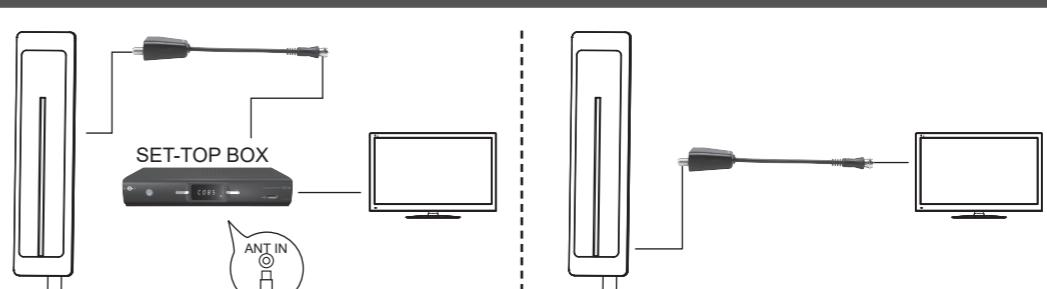
Collegare il cavo del segnale che passa dall'antenna al connettore d'ingresso dell'adattatore di alimentazione, il connettore di uscita del segnale dell'adattatore collegare al ricevitore del segnale digitale e inserire l'adattatore di alimentazione nella spina. Poi collegare il cavo dal ricevitore digitale nel televisore.
