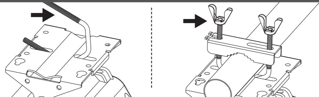
Vložte třmenový šroub do otvoru v držáku antény a nasadte na něj sponu.
